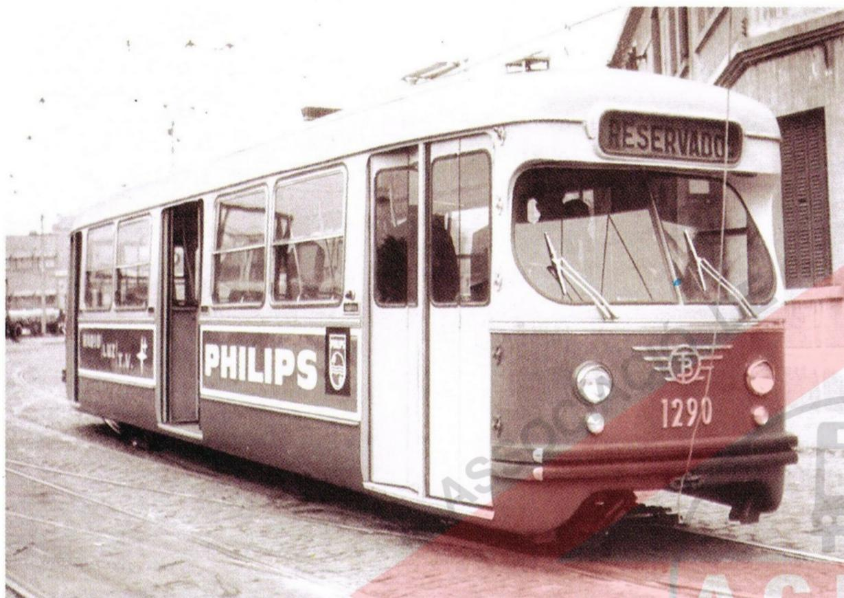
Tramvia 1290 (únic). Va ser fabricat al Taller Central de Sarrià a l'any 1964, prenent com base el bastidor del cotxe 1290
