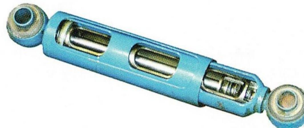
Secció d'un Amortidor
